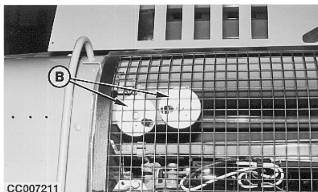
A—Schalter für manuelle Steuerung B—Garnscheiben
