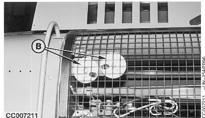
A—Schalter für manuelle Steuerung B—Garnscheiben
