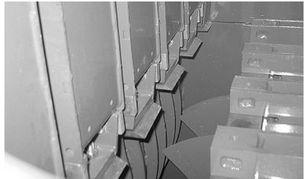
Couteaux centrés entre le contre-couteau et la chambre de précompression
