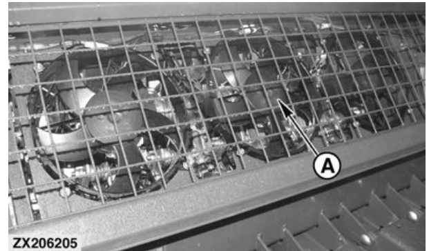
Machine avec ventilateur de nettoyage des noueurs à commande électrique
