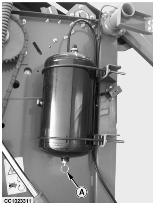
Réservoir d'air pour freins pneumatiques (592)
