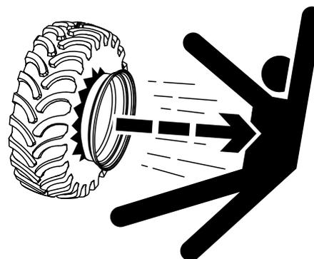
Проверить колеса на предмет низкого давления, порезов, вздутий, поврежденных ободьев или отсутствующих ребристых болтов или гаек.
