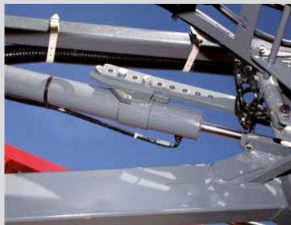
Высота штанги регулируется параллелограммом, контролируемым двумя цилиндрами.
