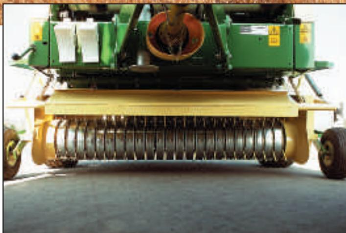
Прессование на поворотах, углах, склонах и с подбором широких валков. Для этих целей требуется широкий подборщик с шириной захвата 1.800 мм в соответствии с DIN 11220. Боковые подающие шнеки обеспечивают постоянный поток массы и плотные края рулонов.
