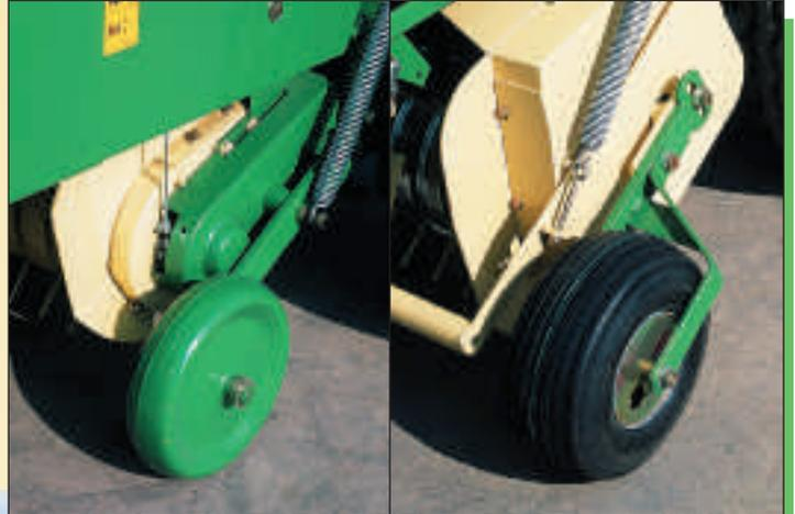
С опорными колесами: для чистого подбора без потерь на ровной поверхности рекомендуется использовать боковые копирующие колеса. Регулируемые по высоте копирующие колеса бывают стальными или оборудованными пневматическими шинами.
