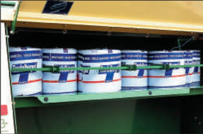
Запас для большого количества рулонов: в отделении для шпагата помещаются до шести катушек шпагата. Укладка новых катушек производится быстро и легко. Крепление обеспечивает надежное позиционирование катушек шпагата.
