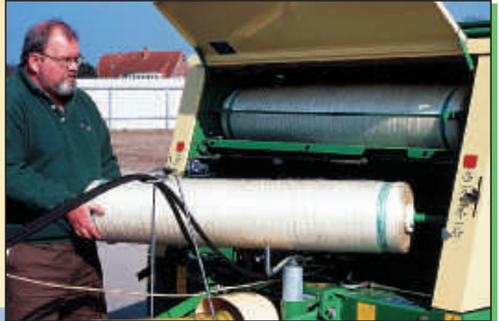
Превосходно: устройство для обвязки сеткой находится спереди в поле зрения механизатора и имеет свободный доступ. Оно рассчитано для рулонов сетки в 2000 или 3000 метров. В отделении для шпагата можно положить дополнительный запасной рулон сетки.
