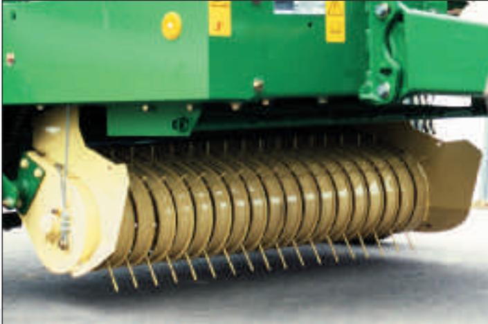
Подборщик на KR 125 имеет ширину захвата 1400 мм в соответствии с DIN 11220, приводится в действие при помощи гидравлической системы и может быть зафиксирован на нужной Вам высоте. Небольшое расстояние от подборщика к прессовальной камере гарантирует постоянный поток кормовой массы.
