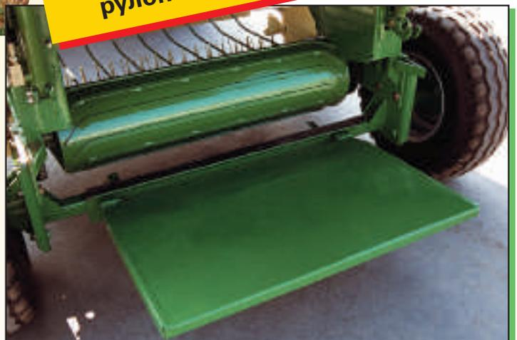
Это есть только у KRONE: комбинация выбрасывателя рулонов и приемного лотка в одном целом! Во время закрытия заднего клапана, после выброса рулона машина уже продолжает движение. В результате этого у Вас получится до шести рулонов больше за час работы!
