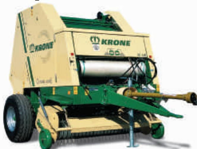
Компактно и качественно: рулонные пресс-подборщики KRONE KR 130 и 160 известны плотными рулонами. Диаметр рулонов в зависимости от типа составляет 1,2 или 1,5 м соответственно, а ширина рулонов – 1,2 м.
