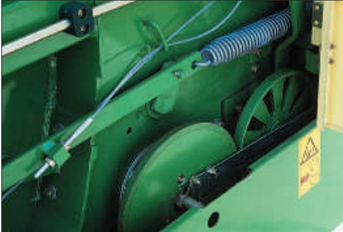
Подача сетки в камеру прессования производится вальцом с резиновым покрытием и алюминиевым вальцом. Боковой фрикционный диск осуществляет привод вальцов при запуске процесса вязки. Количество витков обвязки регулируется бесступенчато.
