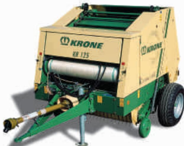
Базовой моделью всех рулонных пресс-подборщиков KRONE является KR 125: с небольшим собственным весом, компактной конструкцией и небольшой потребляемой мощностью. Рулоны имеют диаметр и ширину 1,2 м – идеально для последующей транспортировки и дальнейшего использования.
