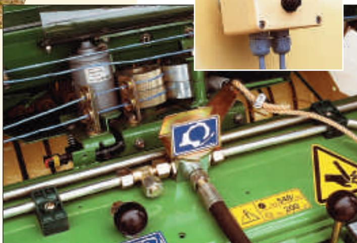
Просто и функционально: достаточно нажатия на кнопку и электрический стартер двойной шпагатной вязки начнет работать (дополнительное оборудование). Приводимые в действие электрическим стартером ролики надежно направляют шпагат в прессовальную камеру.
