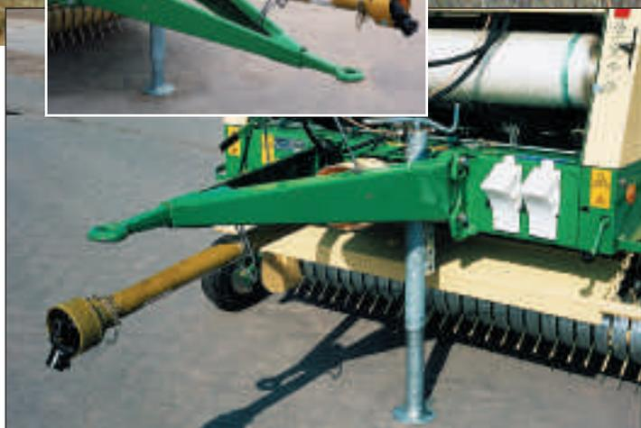
Для любого прицепного устройства: регулировка высоты дышла выполняется быстро и просто. Фиксаторы обеспечивают прочность захвата и стабильность. Путем поворота дышло может быть установлено для работы с верхней или нижней сцепкой трактора.
